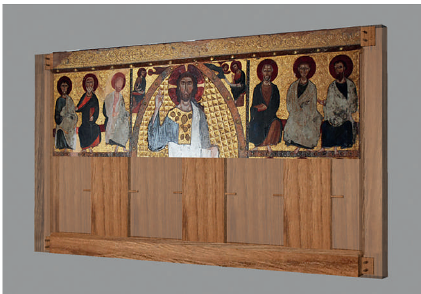
Figura 1. Frontal d'altar d'Orellà. Representació en 3D de les parts que formen el suport de fusta. Semitransparència de les posts 1, 2, 5 i 7 del plafó central, unides amb encaix d'espiga. Semitransparència dels muntants del marc verticals, que permet veure l'encaix de caixa i dues espigues amb els muntants horitzontals. Iris Bautista, 2019.
