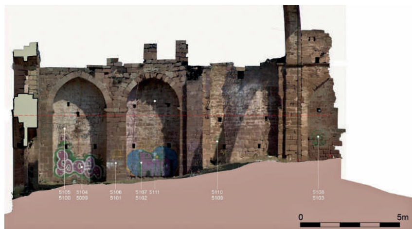
Figura 3. Alçat del parament interior nord de l'església de Sant Genís de Rocafort abans dels treballs de neteja dels grafitis, amb indicació de les UE atribuïdes dins la seqüència estratigràfica. Alfred Mauri, 2019.
