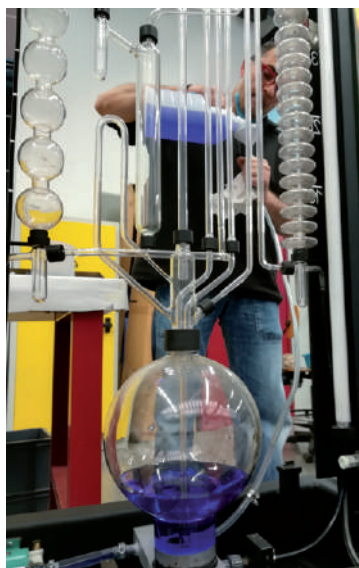
Figura 2. Procés de reompliment de líquid i control d'estanqueïtat. Mercè Gual, 2021.
