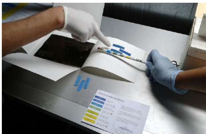
Figura 6. Comparación de la coloración de las tiras de medición de los sistemas A-D Strips y Danchek con los colores de referencia.
