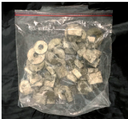
Figura 3. Bossa zip plena de volanderes d'amiant friable tipus crisotil, extret d'una zona de l'emissor. Mireia Garcia, 2020.
